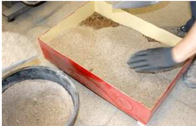
Stahlwanne, Einbau der Bettung
